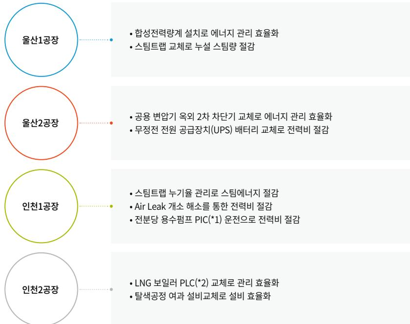
(\*1) PIC (Pressure indicator controller) : 토출 압력에 따른 인버터 Hz 자동 조절 장치
